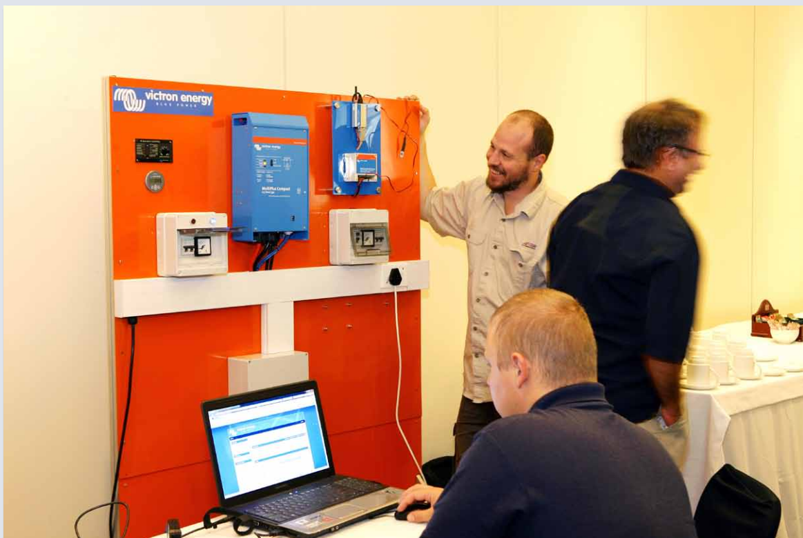
Foto 2: Met de VGR software kan het systeem via een laptop (op afstand) worden geconfigureerd.
