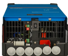
MultiPlus 2 kW (onderkant verwijderd)
